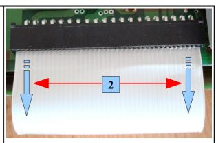
Flachbandkabel gleichmäßig von der Relaisplatine abziehen.
